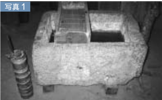
紙製造のための道具 バター茶用の竹筒を利用した紙料液器、石製の紙槽、箆を敷いた浮き箆（民俗村にて）
